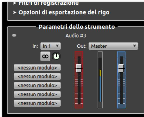
Il blocco ha due potenziometri principali. Un blu per gestire il volume di output. Un rosso per regolare il livello di registrazione. Tra i due c'è un indicatore di livello audio.
